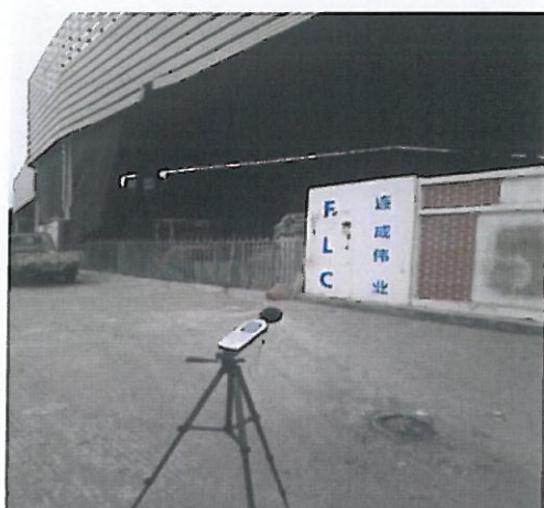
厂界南侧外 1 米处噪声监测点
