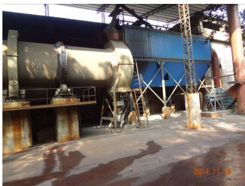
脉冲布袋除尘器（原料干燥机含尘废气）
