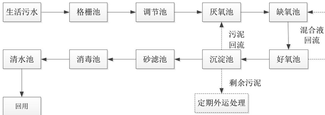
图 5.2-3 生活污水回用工艺流程图
