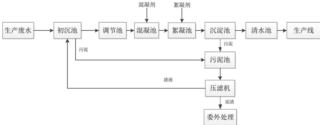
图 5.2-1 生产废水处理工艺流程图
