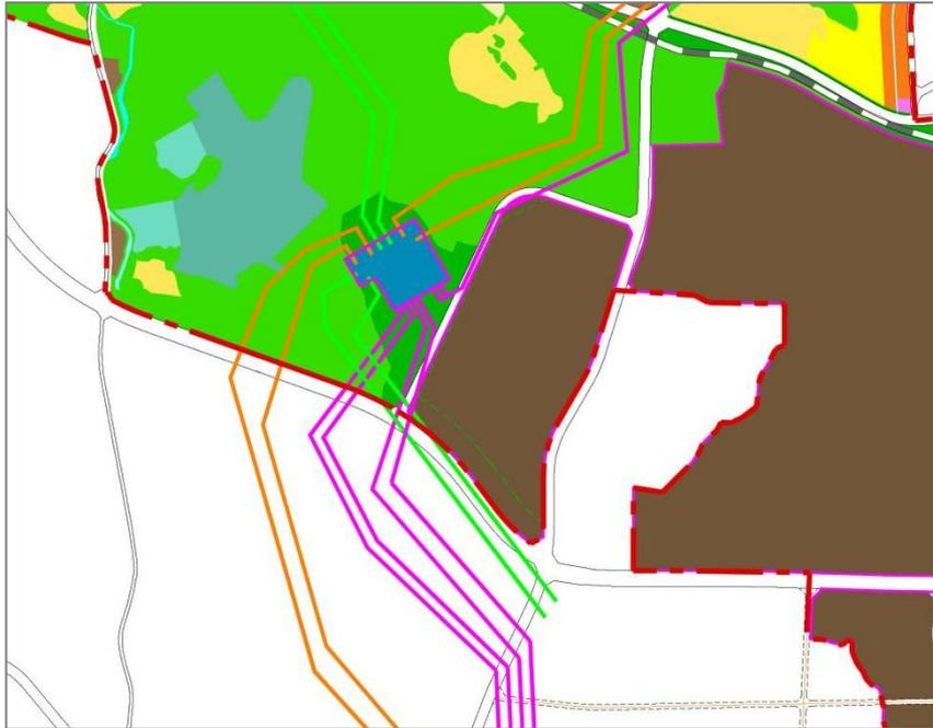
图 4-5 500 千伏云城站线路路径方案规划图
