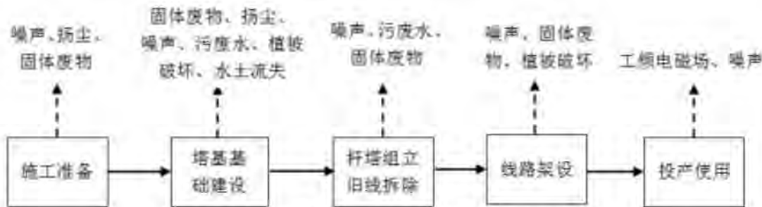
图 2-6 架空线路工程工艺流程及产污环节
